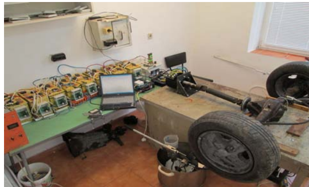
Фиг. 1 Стенд за изпитване на тягови батерии
